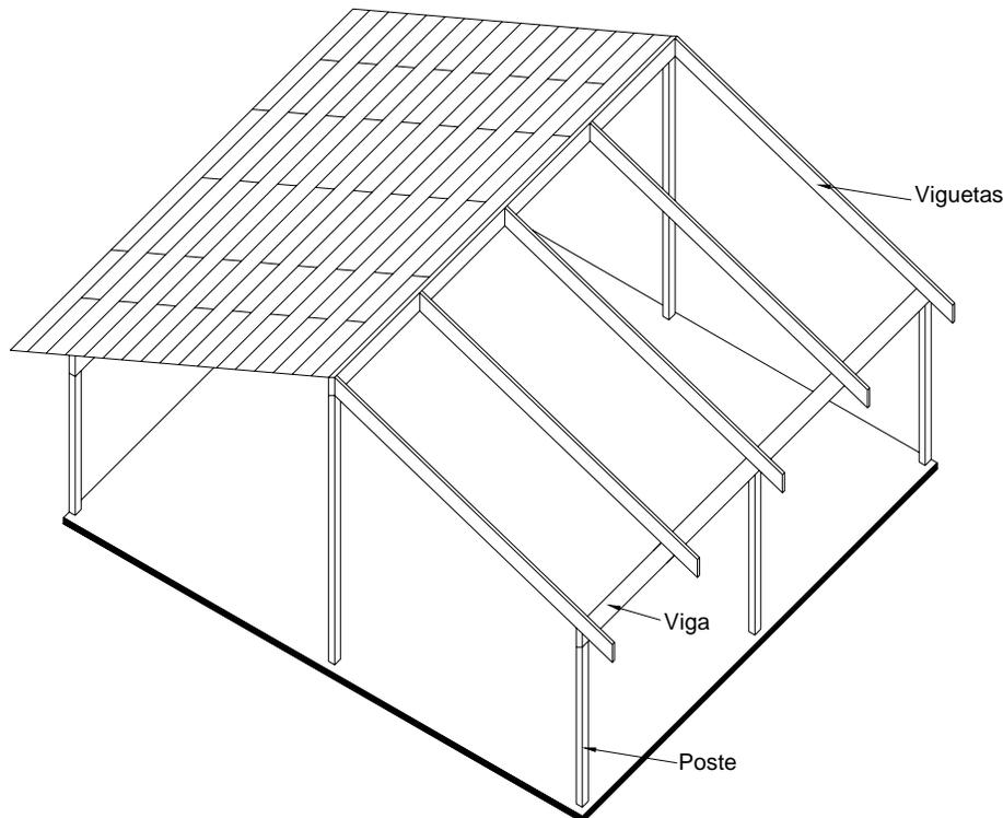
Figura G.9.3-2 — Sistema de poste y viga
