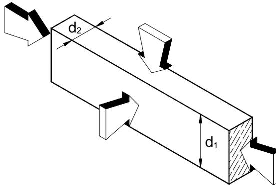
Figura G.5.2-1 — Flexión combinada y compresión axial
