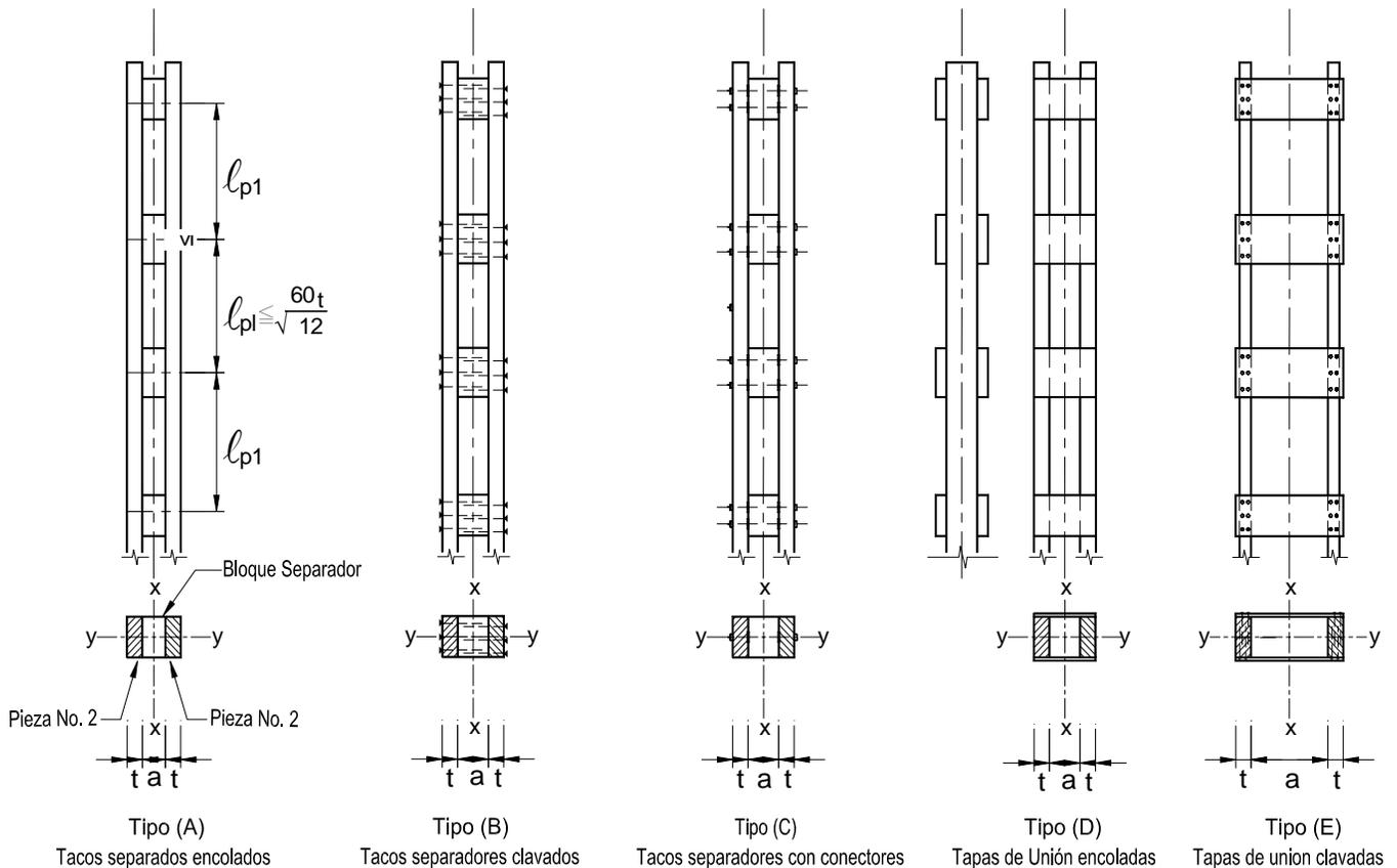
Figura G 4.3-3 — Columnas compuestas espaciadas
