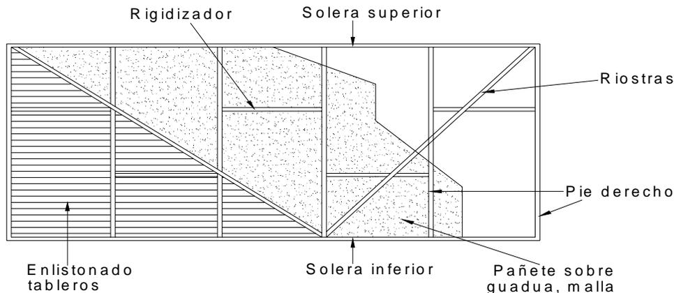
**Figura G.7.3-1 — Elementos de los muros de corte**
