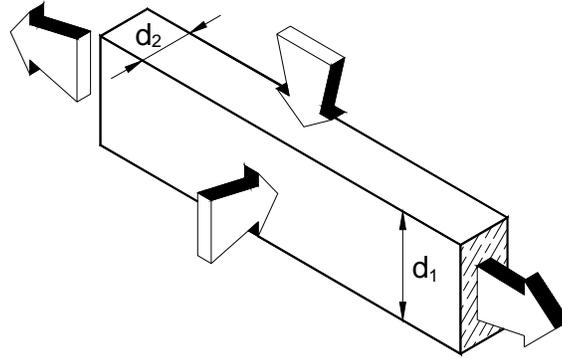
Figura G.5.1-1 — Flexión combinada y tensión axial
