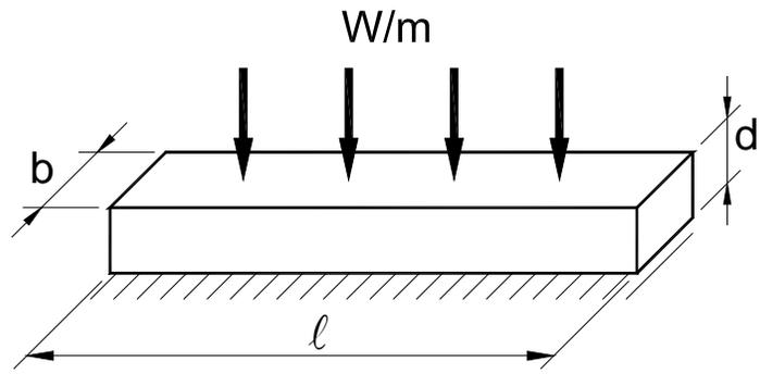
Figura G.3.5-2 — Deformabilidad por aplastamiento
