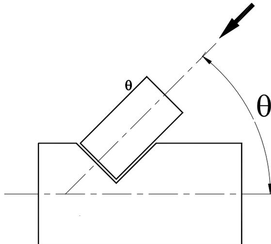
Figura G.3.5-1 — Cargas inclinadas
